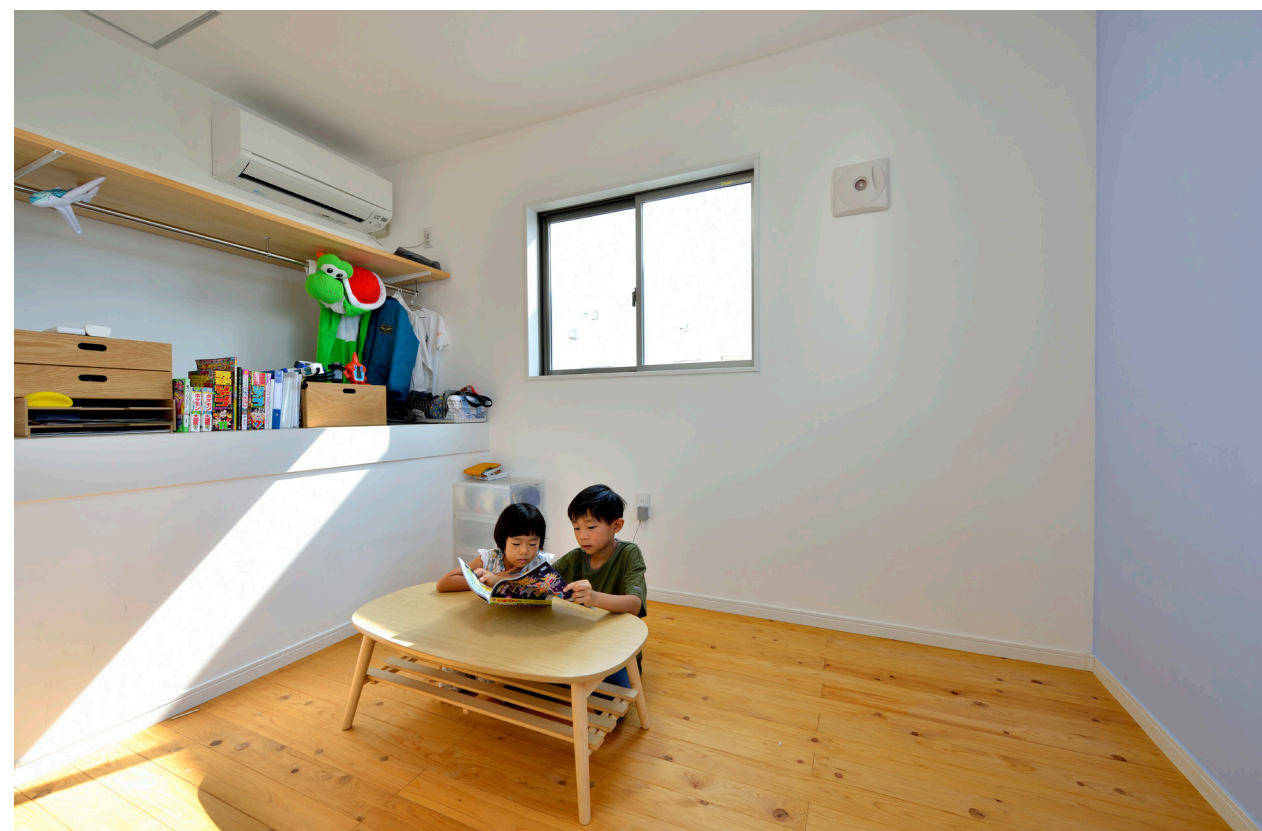
子ども室。居室は全て自然由来の仕上げ材を使用。壁は調湿性の高いボードの上に漆喰調塗装、床や柱などは自然オイル「リボス」を塗布
